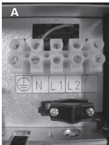
Рисунок 10 А и В. 2-фазные электрические соединения каменки
