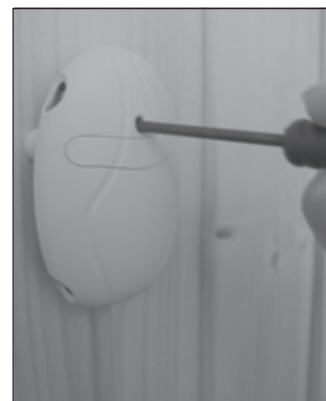
Рисунок 11. Кнопка сброса устройства защиты от перегрева
