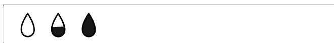
Rysunek 5: Kontrolka WILGOTNOŚĆ/STAN WILGOTNOŚCI dla pustego, w połowie pełnego i pełnego zbiornika
